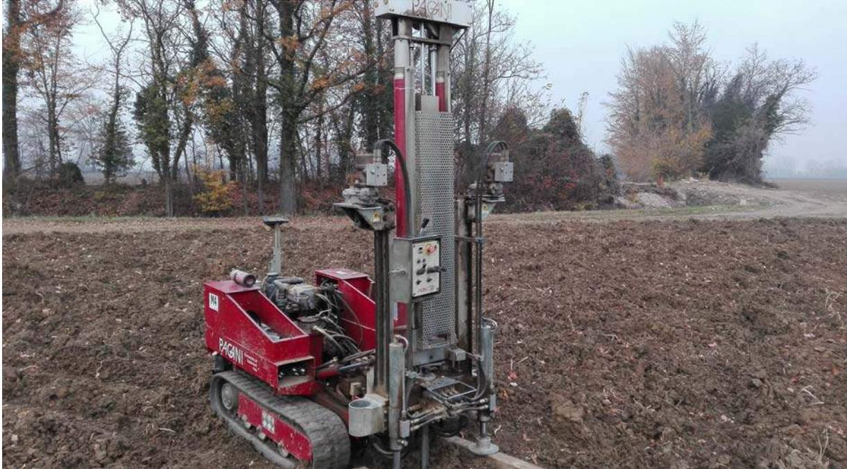
Fig. 2 – Particolare fotografico delle prove SCPT1
